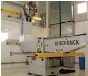
En el sistema de propiedades de masa se miden pesos de hasta 4 tn. con una precisión de 100 grs.
