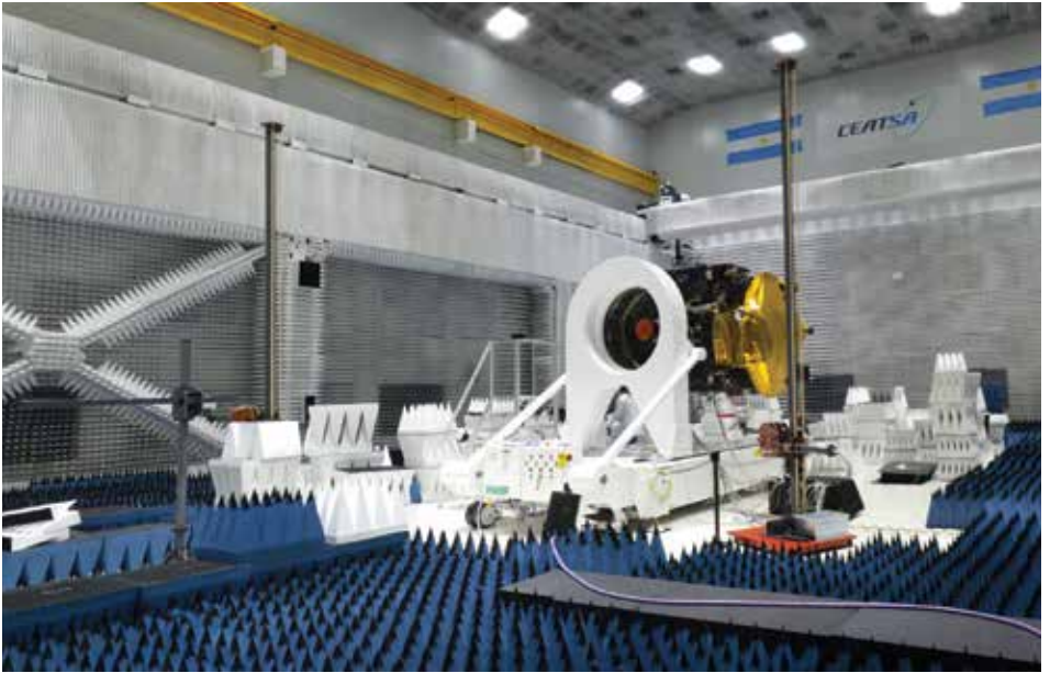
Cámara anecoica CEATSA
