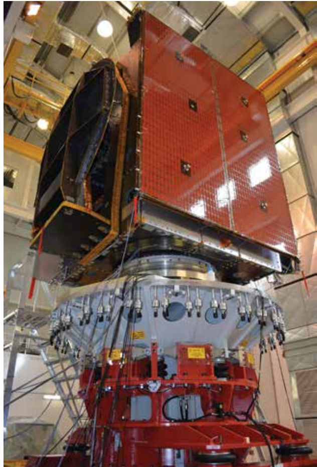
En el "shaker" se simulan las intensas vibraciones que soporta el satélite en el lanzamiento.
